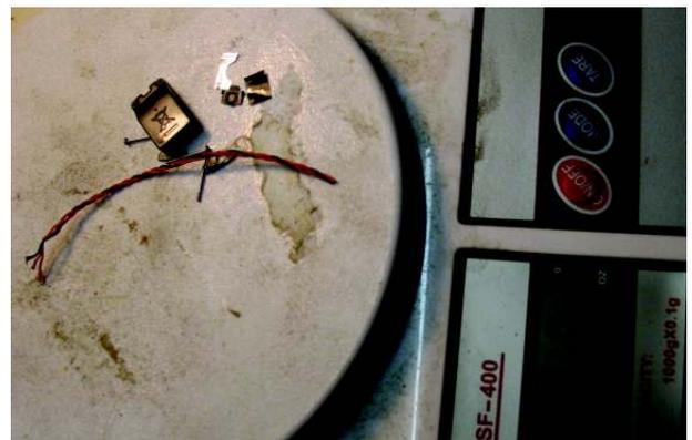
Spart pro Servo ca. 0.8g, bei 3 Servos 2.5 g oder mehr als 3% des Abfluggewichtes
