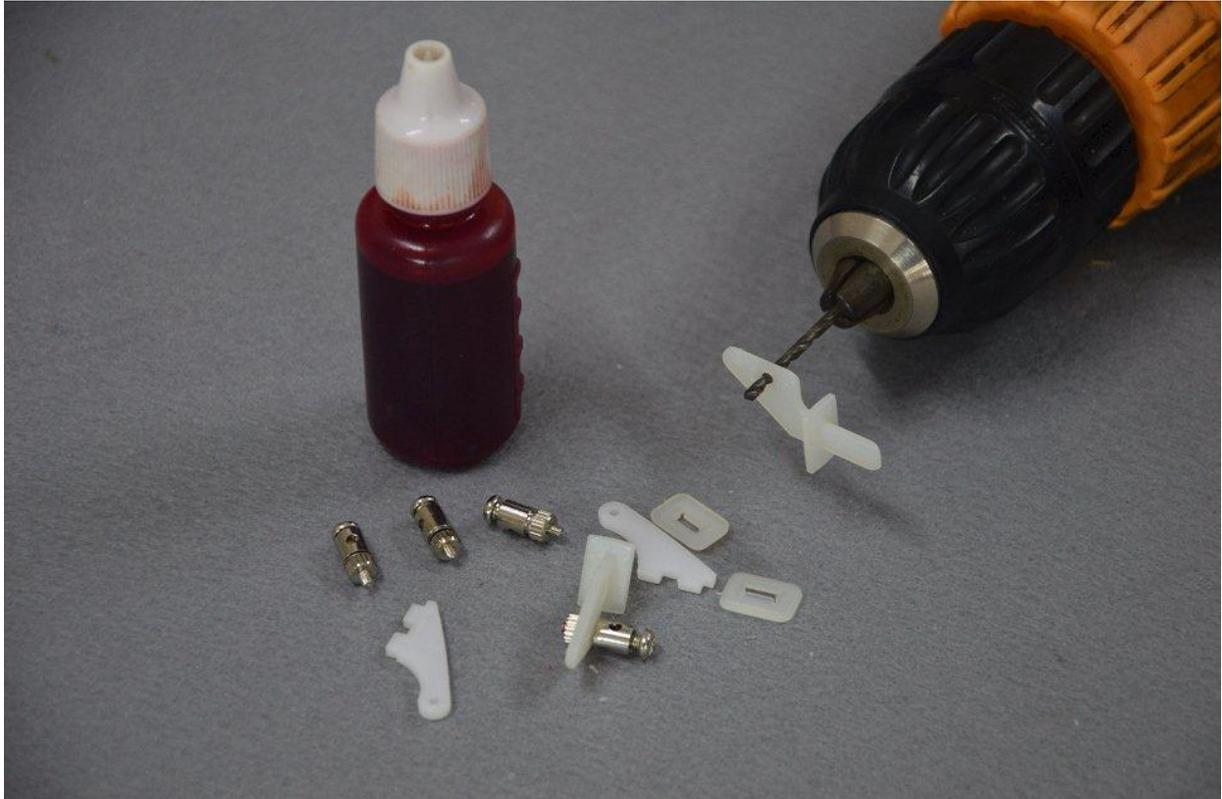
Lenkhörner mit 1.5mm Bohrer aufbohren und die Anlenkstopper montieren.
