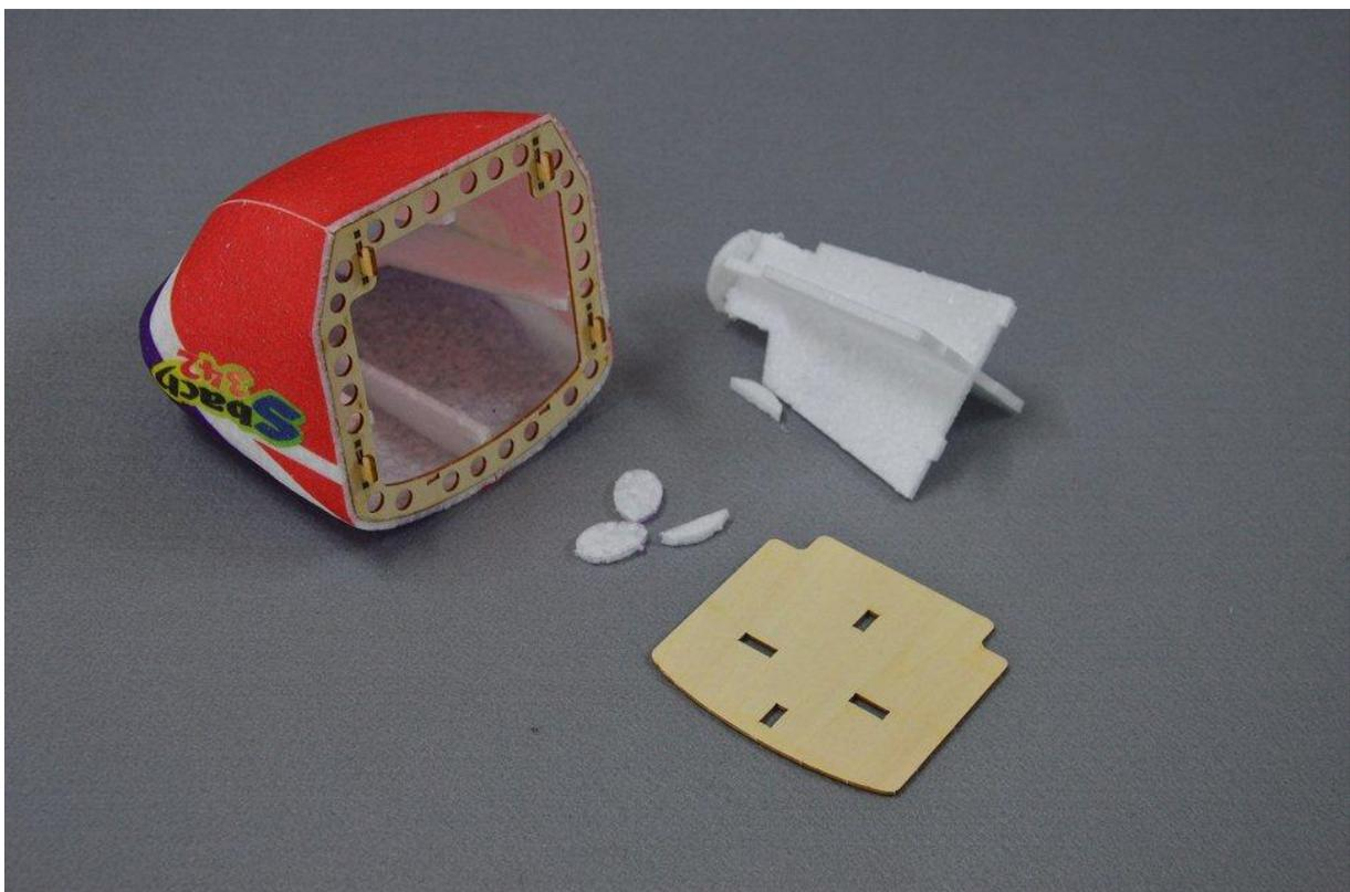
Motorhaube vorbereiten, Innenteile rausbrechen/schneiden.
