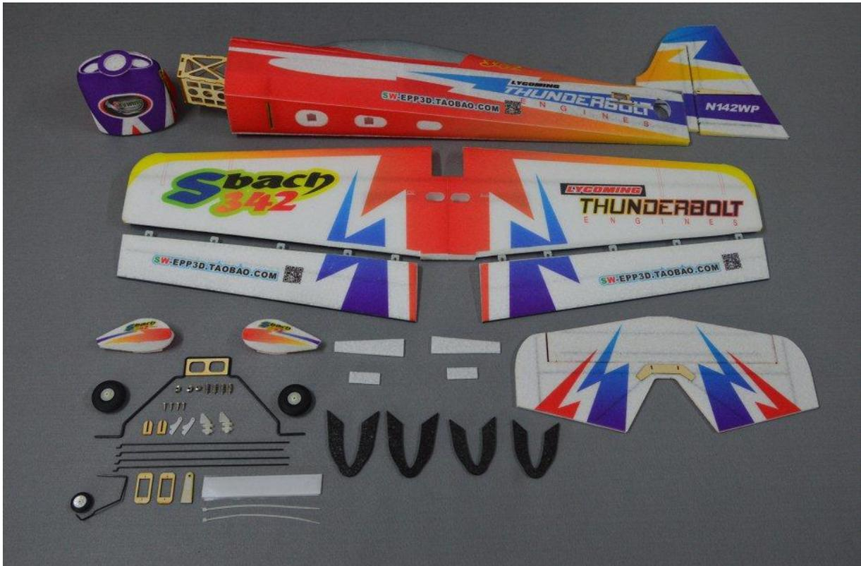
Baukasteninhalt Sbach 342: die bemalten Teile wie Rumpf, Flächen, Ruder sind fertig gebaut, geklebt und inwendig mit Carbon verstärkt. Die Scharniere sind auf einer Seite bereits eingeklebt, die Aussparungen auf der anderen Seite bereits geschnitten. Die Anlenkungen sind optimal vorbereitet.
