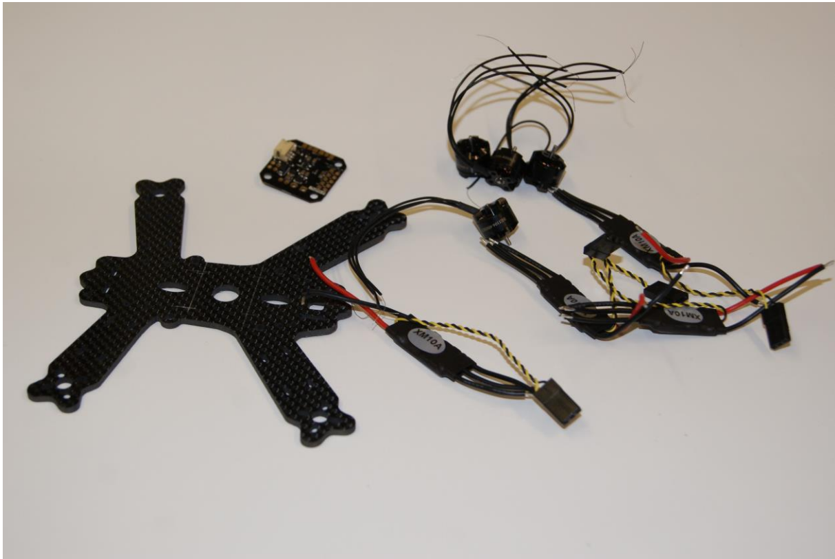
DYS F1104 Power Combo Set, 4x Motoren & 4x ESC, FC inkl. PDB 20x20mm
