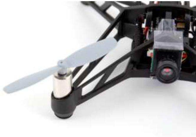
2. Löten sie die beiden Kabel vom Controller ab. Merken sie sich welche Farbe wo war um den Ersatzmotor wieder gleich anlöten zu können. Die Nummer am Lötpad entspricht der Motor Nummer in Betaflight.
