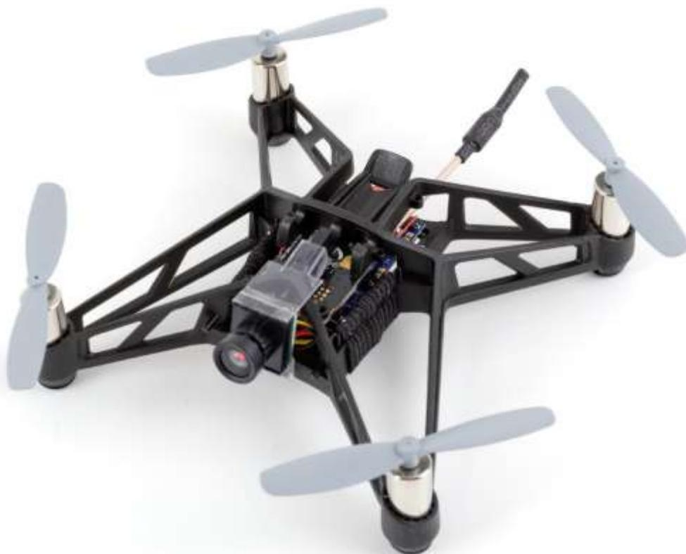
Ein Frame von Parrot bestückt mit BetaFlight Flugkontroller, Spektrum R/C Empfänger und einem TBS UNIFY PRO Video Sender. Geeignet für Indoor Fliegen und oder Flüge ums Haus und in der Lagerhalle.
