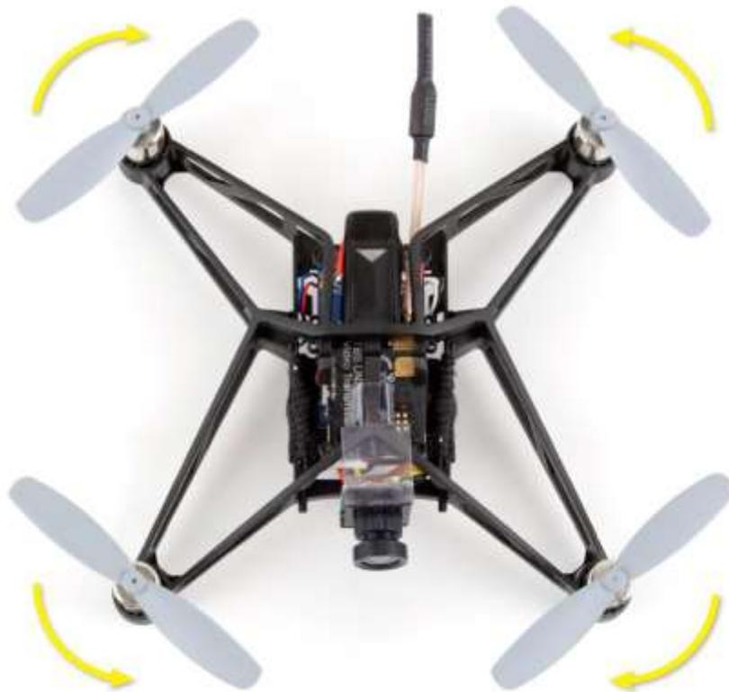
3. Stecken sie die Propeller wie auf dem Bild gezeigt auf die Motor Wellen. Sie können sich die Drehrichtung einfach einprägen wenn sie sich merken dass Vorne Links und hinten Rechts im Uhrzeigersinn dreht die anderen im Gegenuhrzeigersinn. Zwei nebeneinander liegende Propeller drehen immer gegenläufig.
