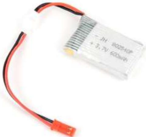
Das Kit wird mit einem passenden Ladekabel geliefert. Den Roten JST Stecker tauschen sie wenn nötig durch einen Stecker ihres Ladesystems aus.
